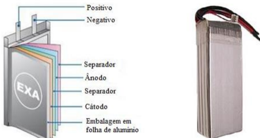
Figura 34 - Esquema de uma bateria LiPo [70]
