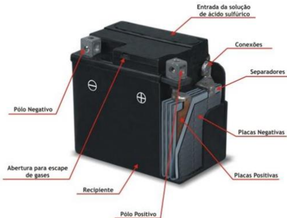
Figura 30 - Constituição de uma bateria de chumbo-ácido [57]
