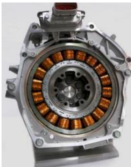
Figura 11 - Motor PMSM de fluxo radial do Honda IMA [28]
