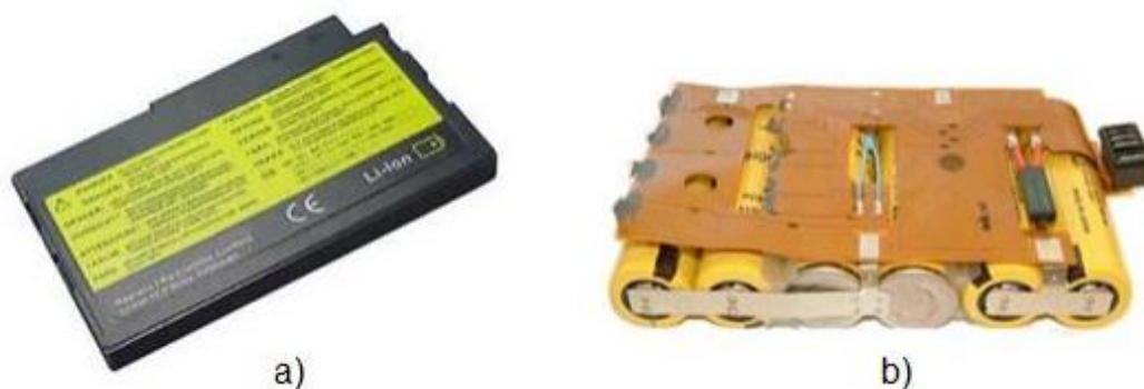
Figura 33 - a) Bateria Li-ion de computador portátil IBM Thinkpad, b) interior da mesma bateria onde se vê o BMS (folha de circuitos por cima das células) [68]
