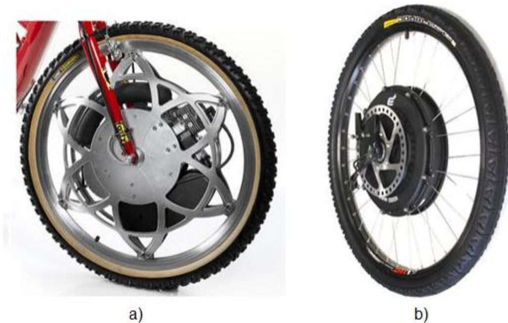
Figura 17 – Motores aplicados em cubos de rodas de bicicletas: a) motor de combustão interna [38], b) motor elétrico [39]
